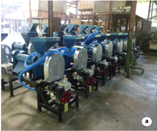
Produk alat mesin pengolahan hulu kopi (a) dan pengolahan hilir kakao skala rumah tangga (b)
