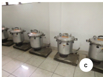
Sterilisasi alat dan media; sterilisasi petridish dengan menggunakan bunsen (lampu spiritus) (a), laminar air flow cabinet yang telah steril dan siap digunakan untuk kegiatan kultur (b), peralatan kultur disterilisasi dengan menggunakan autoclave (c)
