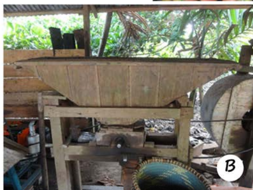
Standar panen kopi Liberika di Tanjabar (A), alat pecah kulit kopi Liberika (knesser) (B), biji hasil proses pecah kulit (C)
